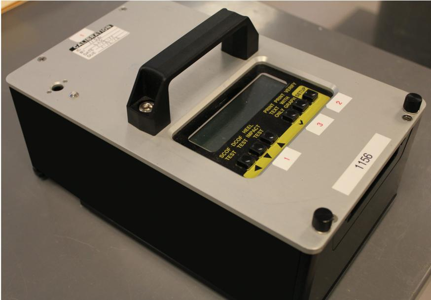
*New Test Method: BOT-3000 (Tribometer)*
